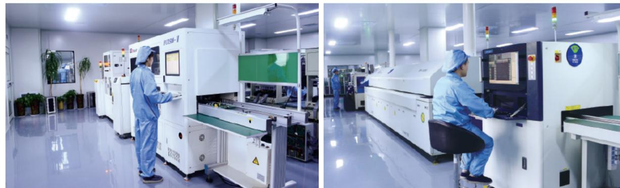
PCB 板调试 -FCT、ICT 功能测试流水线
